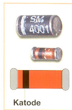
Bild 6: Standard bei Universal- dioden - das MELF-Gehäuse
