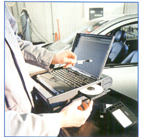
Bild 3: Update über Laptop per CD-ROM oder Internet - heute schon Realität in den Werkstätten. Bild: Daimler Chrysler
