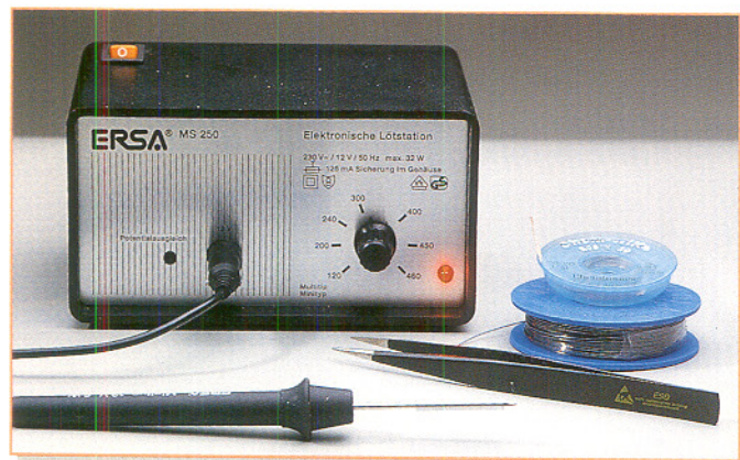
Bild 14: Die Grundausrüstung für das Bestücken von SMD-Bauteilen
