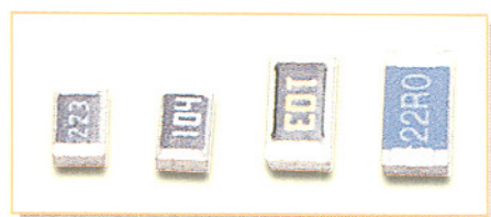
Bild 1: SMD-Widerstände in unterschiedlichen Größen (0805 und 1206).
