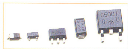
Bild 7: Dioden werden je nach Leistungsklasse in unterschiedlichen Gehäuseformen geliefert.
