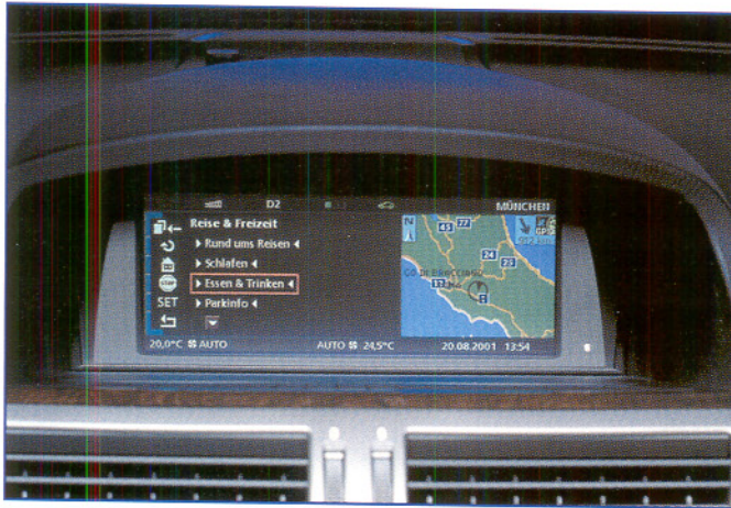
Bild 4: Dank offener Softwarestrukturen kann man z. B. Navigationssysteme absolut aktuell mit Daten versorgen und so sogar kurze Staus oder andere Verkehrsbehinderungen anzeigen lassen. Bild: BMW
