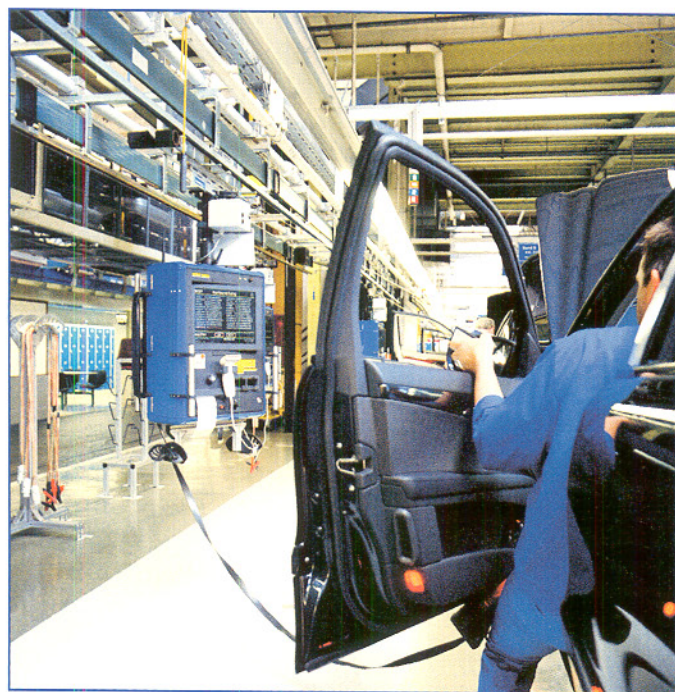
Bild 7: Das fertige Auto bekommt am Schluss des Produktionsprozesses seine „Betriebssoftware“ eingespielt - Daimler Chrysler nennt den Prozess treffend „flashen“. Bild: Daimler Chrysler
